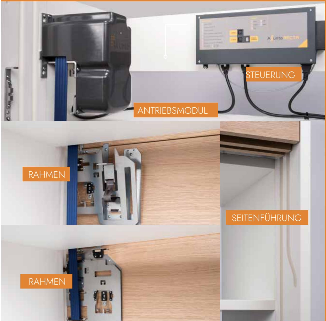
Assunta ist sehr einfach aufgebaut. Das System besteht aus **2 Antriebsmodulen**, einer **Steuerbox** und **Rahmen**, die an den Paneelen befestigt werden. Die Rahmen für die Paneele enthalten alle notwendigen Komponenten und werden als eine Einheit auf das Paneel geschraubt. Dies führt zu einer **sehr einfachen und schnellen Montage**. Die Rahmen sind je nach Paneel unterschiedlich: Für das untere Paneel sind die Rahmen mit Führungsrädern und Befesti-
